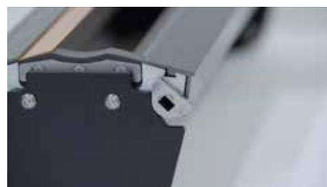
Sistema di fissaggio rapido della camera TRESU
