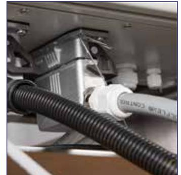
Pronto per Industry 4.0 e sensore che indica la rottura del tubo flessibile
