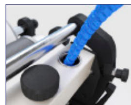
Riempimento manuale e rabbocco o collegamento a un circolatore
